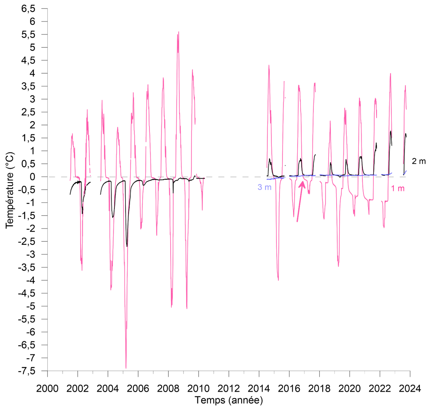
Figure 20 : Températures en fonction du temps des thermistances à 1, 2 et 3 m de profondeur du câble à thermistances HT176 sur le versant sud-ouest de la lithalse SB dans la vallée Tasiapik à Umiujaq. La thermistance à 1 m de profondeur commence à dériver en 2017 (flèche rose).
